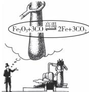
问题一：炼铁工程师设法增加高炉的高度，高炉尾气中 CO 的比例竟然没有改变，其原因是什么？
