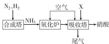
A. 氧化炉中发生的化学反应是  $4\text{NH}_3 + 5\text{O}_2 \xrightarrow[\Delta]{\text{催化剂}} 4\text{NO} + 6\text{H}_2\text{O}$
